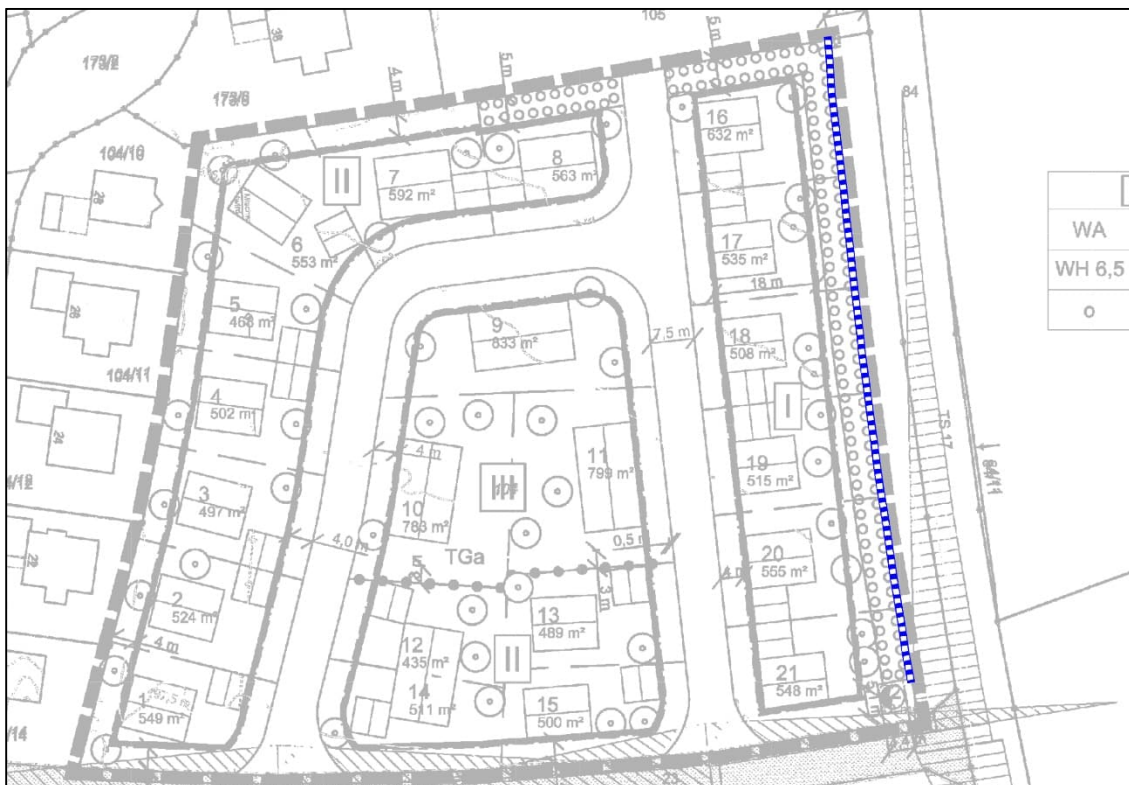
Abbildung 5: Lageplan mit Darstellung der zu errichtenden Lärmschutzanlage
