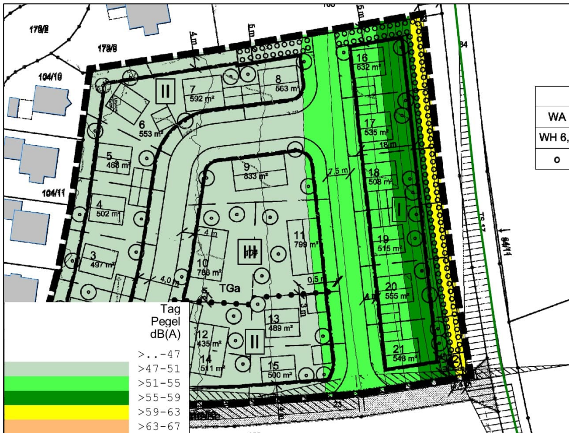
Abbildung 4: Lärmelastkarte mit Darstellung der Geräuschsituation in 2,0 m über Gelände im Falle einer Geschwindigkeitsreduzierung auf der Kreisstraße TS 17 (ohne Lärmschutzwand)
